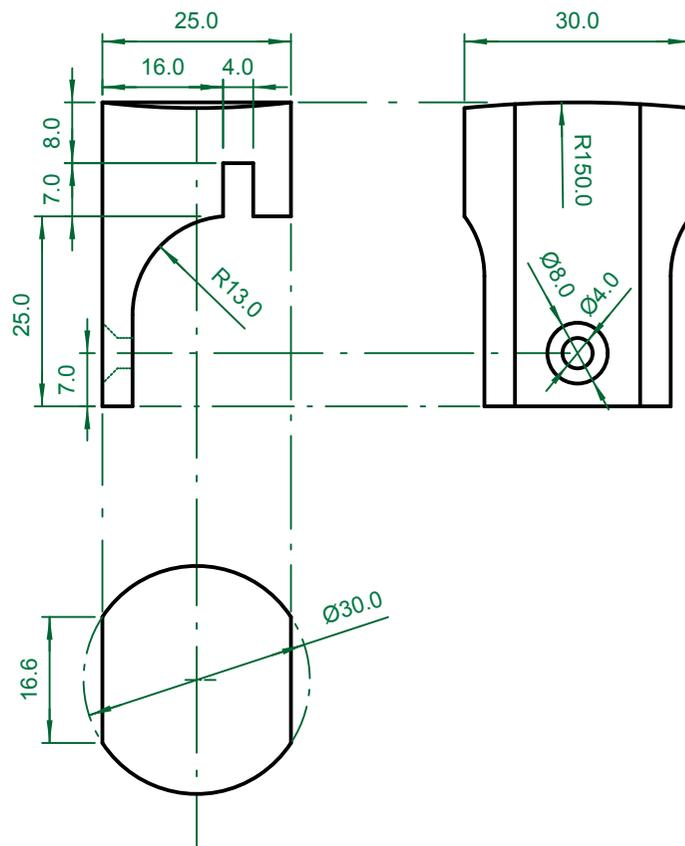
Ketten-Gleitstück, Polyamid (1x)
